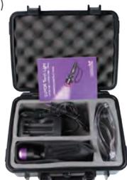
LUYOR-2130L紫外线手电筒是采用3颗大功率长波紫外线LED(UVA LED 365NM) 做为光源,输出大面积的紫外线, 内置1只大容量锂电池组, 充满电能够连续工作2-3小时, 紧凑的设计, 小巧的机身能够携带到非常狭小的空间工作, 特别适合荧光渗透检测、荧光磁粉检测、生物检材发现、脱脂清洗等行业。
