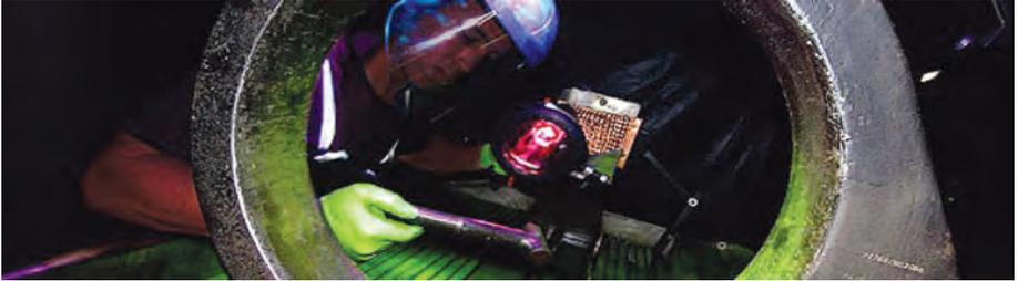
LUYOR-3101H采用上海路阳最新研制LED高强度紫外光源，紫外LED光源比原来的高压汞灯紫外线灯管更有效率、更节省电量，LUYOR-3101H采用头戴式，解脱双手，操作方便。LUYOR-3101H头盔式紫外线灯发出的高强度紫外线，在38cm处紫外线强度高达8000uw/cm<sup>2</sup>。LUYOR-3101H头盔式紫外线灯是目前世界上最小巧的高强度LED紫外线灯。
