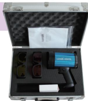
LUYOR-3260系列便携式荧光蛋白激发led光源，采用多颗大功率led光源，手电筒式设计，电池供电，照射面积大，光斑均匀，能够激发绿色荧光蛋白(GFP)，红色荧光蛋白的荧光（dsred），被广泛用于研究所、高校等生物研究部门。
